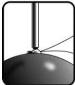
Обычный способ сварки заключается в нагреве металлической поверхности, которая является хорошим проводником. Таким образом на поверхности появляется минимальный сварной шов
