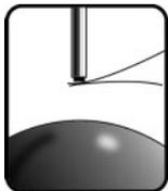
1. Нагретый электрод плавит металлическую поверхность;
