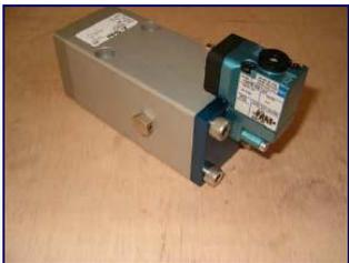
**I** 2 пилотных клапана **130B-500JJ Mod. EF08**
