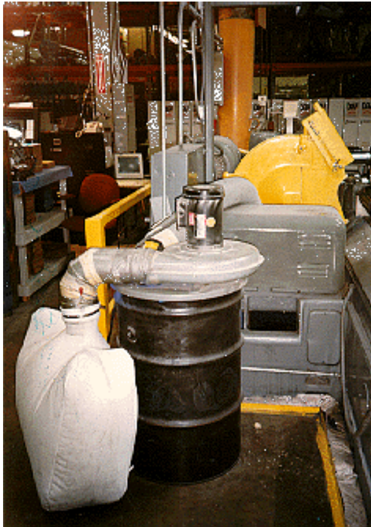
Рис. 80.9 Пылесборник шлифовального круга улавливает резиновую пыль
